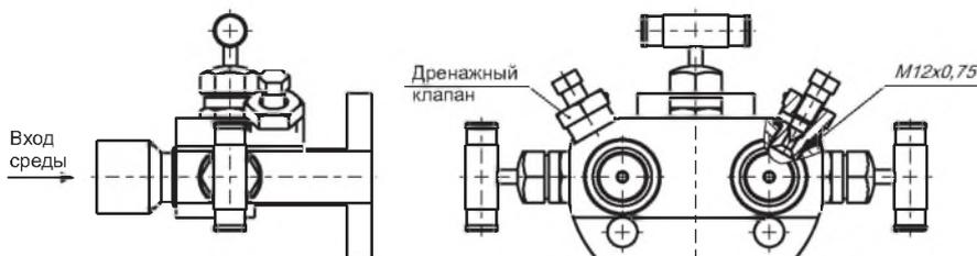
Трехвентильный клапанный блок ВКВ31 P1
