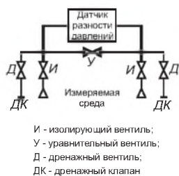
Гидравлическая схема тип 2 для пятивентильного клапанного блока: дренажные клапаны после изолирующего вентиля
