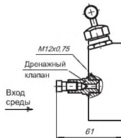
Трехвентильный клапанный блок ВКС31 P10
