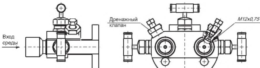
Трехвентильный клапанный блок ВКВ31 P1
