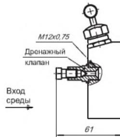
Трехвентильный клапанный блок ВК31 P10
