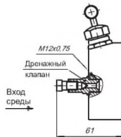
Трехвентильный клапанный блок ВК31 P10
